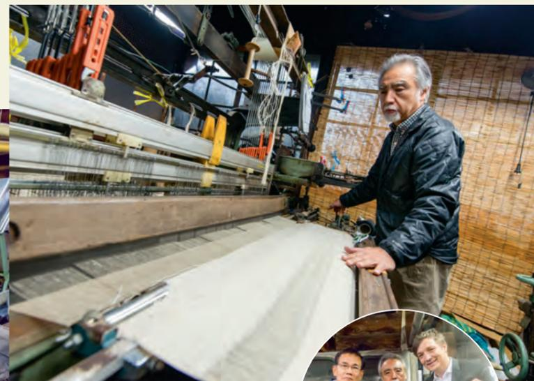
(写真左)真ん中の細い糸が電気を通す特別な糸。その糸を16本の糸で燃(よ)り合わせて水や熱にも強い糸を生成。(中)水や熱に強くなった糸を染色工場で染色し、(右)従来からある織機で布を生成する。これらの工程は職人の確かな技術力が要求される。
